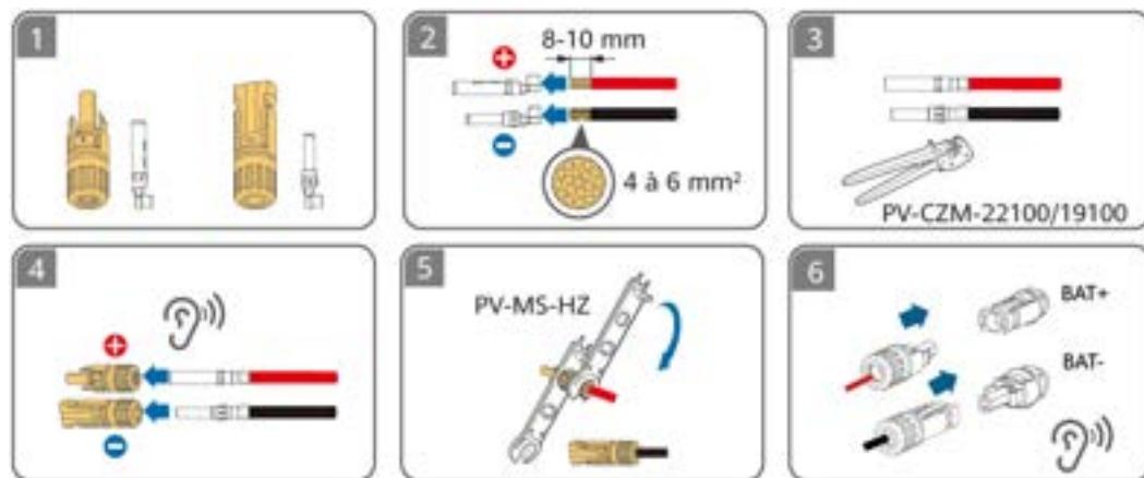
Dans un système en parallèle, connectez les câbles d'alimentation CC entre les ESS en vous référant aux connexions de câbles entre l'onduleur et un ESS.
